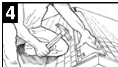
Appliquer l'évent de sorte que la charnière soit centrée le long du sommet, ce qui permet à la bride de reposer sur le support de couverture du toit (**voir vue 4a**) à l'opposé de l'ouverture de la fente. Fixez le corps de l'évent de toit à l'aide de clous de toiture à anneau de 2.5" et clouez à travers (2) les trous pilotes prévus sur le corps de l'évent.
