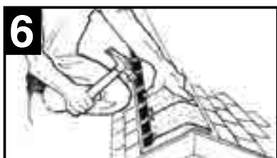
Installer le nouveau faîtement en alignant le bord du bardage avec le capuchon de l'évent. Fixer le faîtement en le clouant à travers le corps de l'évent dans le support de couverture du toit d'un côté et en le clouant directement dans la couche de bardage/support de couverture existants de l'autre.
